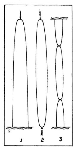
Sea una columna de altura h cargada con un peso P. Como la deformación debe ser virtual, el trabajo total producido tanto por la flexión de la pieza como por el descenso e del peso p, será con errores de orden superior:
