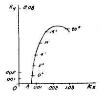
Si sobre dos ejes de coordenadas rectangulares colocamos Kx en abscisas y Ky en ordenadas, se obtiene una curva de forma parabólica, que deberá ser de terminada experimentalmente para cada ala. Esta curva se llama la *polar del ala*;
