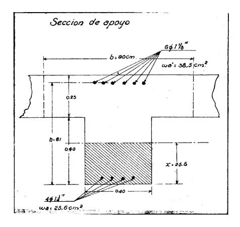
La posición del eje neutro queda determinada por la ecuación:
